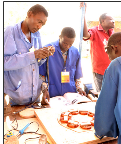
Assemblage des bobines
